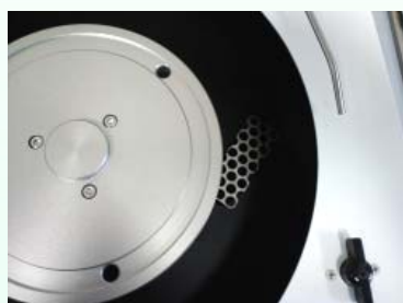
排水孔安装过滤网
